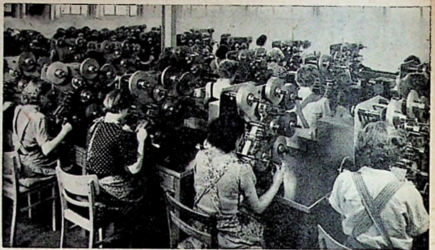
De fabricage van condensatoren zoals deze in de WIMA-fabrieken wordt toegepast (UCO-foto).
